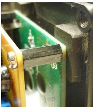
Se si vuole tenere il display allo stesso livello della parete anteriore della scatola occorre fissare lo stesso mediante delle piastrine a spessore di plexiglas o altro materiale isolante. Al centro di ciascuna piastrina sarà fissata una vite M3 con testa svasata sufficientemente lunga da poter prendere anche parte del distanziale. Sul gambo di ciascuna vite andrà inserito l'LCD ed una volta verificata l'esatta posizione del display
